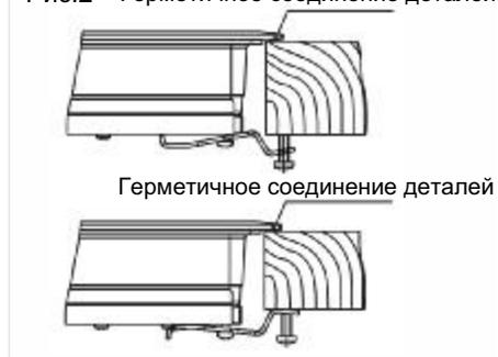
В зависимости от толщины столешницы секции может быть необходимым использовать самонарезающие винты (M5), которые поставляются в качестве дополнительных принадлежностей для крепления; вставьте их в круглые отверстия кронштейна. Резьба в отверстиях будет нарезать, когда винт вставляется в него. необходимо сделать резьбу до закрепления кронштейна в панели.
